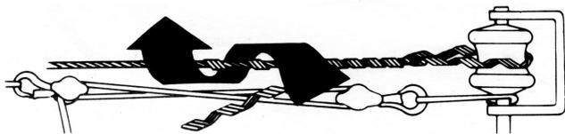
3. Introduza a segunda perna da Alça envolvendo a roldana e aplique-a sobre a cordoalha, fazendo coincidir as marcas coloridas de início da aplicação. Complete a aplicação da Alça sobre o cordoalha.
