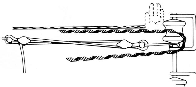
1. Tracione a cordoalha e corte-a a uma distância de aproximadamente uma mão do isolador. Faça coincidir a curva da Alça com a ranhura do isolador.
