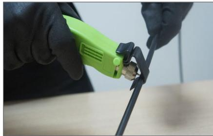
2. Con un rodillo longitudinal, abrir el cable óptico con una longitud mínima de 1,5 m.
