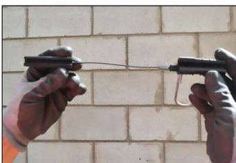
2.1. El SRDO está compuesto por tres partes: NÚCLEO y CUERPO unidos por el Cordón plástico y GANCHO METÁLICO.
