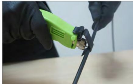
**6.2.** Con un rodillo longitudinal, abrir el cable óptico con una longitud mínima de 1,4 m.
