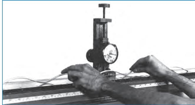
Durante la producción se realiza una inspección por muestreo para su control dimensional. El proceso de fabricación de las varillas es auto selectivo, o sea, cualquier anomalía en la composición y en las propiedades mecánicas del alambro ó del hilo se refleja en las dimensiones de la hélice y resulta en la imposibilidad del "hermanado" de las varillas, hecho éste forzosamente notado durante el proceso de fabricación.
