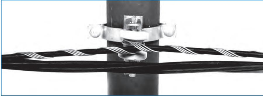
La Atadura Preformada - SPL se destina al amarre del conductor con neutro aislado ó recubierto de los cables preensamblados en aisladores roldana. Se aplica directamente sobre el aislador roldana.
