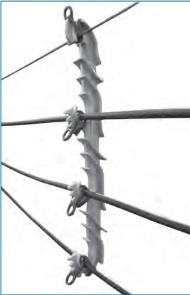
Accesorio de formato vertical para utilización en líneas compactas clase 15 kV. Colgado de un cable mensajero su función es la sustentación y separación de los cables protegidos en las conexiones en los vanos (flying – tap), manteniendo la aislación eléctrica de la línea.
