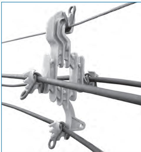
Accesorio de formato poligonal para utilización en líneas compactas clase 15 kV. Colgado de un cable mensajero, su función es la sustentación y separación de los cables protegidos a lo largo del vano, manteniendo la aislación eléctrica de la línea.
