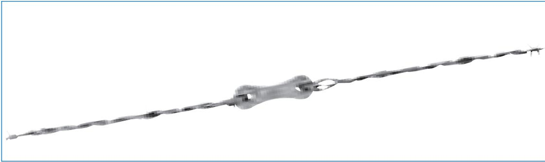
El Seccionador Preformado para Cercos – SCM se destina al seccionamiento eléctrico de alambre de púas o alambre liso, en los alambrados que corren paralelamente ó son cortados por las líneas de transmisión o distribución de energía eléctrica.
