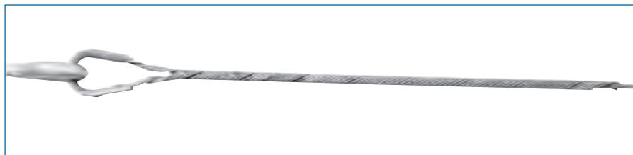
La Retención Preformada para Cables de Acero – GDE se destina al anclaje de cables de acero galvanizado y cables de acero recubiertos de aluminio respectivamente, sujetos a esfuerzos de tracción sin torsión. Dependiendo del caso, debe ser utilizada en conjunto con guardacabo ó guardacabo con horquilla.
