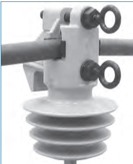
El Aislador Polimérico Vice-Top con garras de PLP se utiliza en Redes Aéreas de Distribución de Energía Eléctrica, clase de tensión 15 KV ó 35 KV, para su aplicación en cables protegidos (puede ser aplicado también en cables desnudos; en ese caso, será necesario el cambio de los mordientes poliméricos por metálicos). El aislador fue desarrollado para cubrir los parámetros eléctricos y mecánicos en ambientes típicos para ese tipo de redes.
