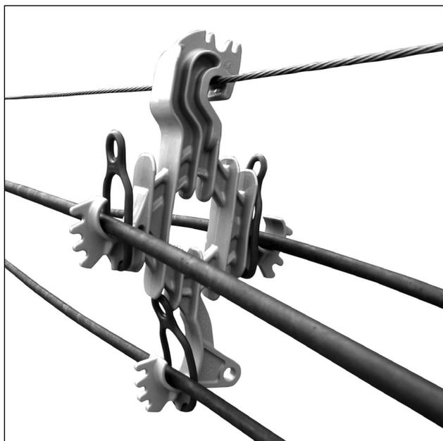
**2.2** Posicione o Espaçador com os Anéis sobre o cabo mensageiro e encaixe os condutores revestidos sobre as garras.
