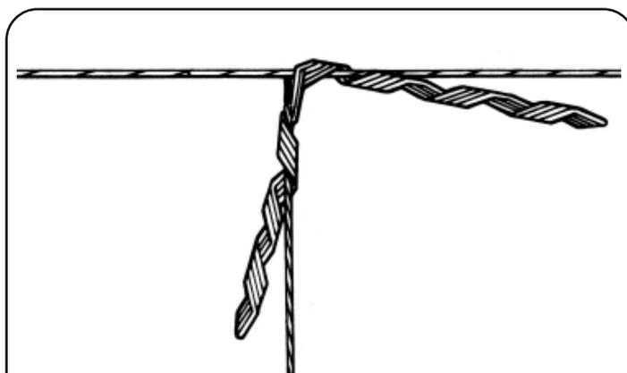
**2.** A partir da marca colorida, inicie a aplicação fazendo passar uma perna do Conector sobre o arame da cerca e a outra perna pelo fio de aterramento. Aplique cada perna dando duas voltas. Em seguida, complete a aplicação.
