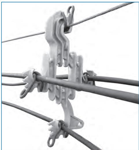
Accesorio de formato poligonal para utilización en líneas compactas clase 15 kV. Colgado de un cable mensajero, su función es la sustentación y separación de los cables protegidos a lo largo del vano, manteniendo la aislación eléctrica de la línea.
